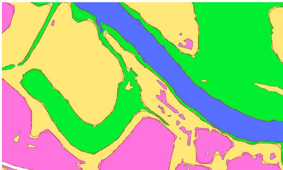
Rysunek 11. Raster głębokości wody po dwukrotnym wygładzeniu za pomocą narzędzia ArcGIS Majority Filter, warstwa poligonowa po wstępnym wygładzeniu (linia czarna), poligony stref głębokości po generalizacji i ostatecznym wygładzeniu narzędziem ArcGIS Smooth Polygon z algorytmem PEAK (Polynomial Approximation with Exponential Kernel) (linia czerwona)
